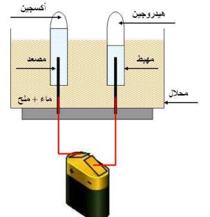
عندما يسري التيار الكهربائي خلال خلية التحليل الكهربائي، تحدث تغيرات كيميائية عند سطح كل من القطبين الكهربائيين. فعند المهبط (الكاثود) يتحد السائل المتحلل مع الإلكترونات القادمة من البطارية،
